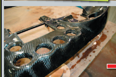
après le séchage et le ponçage, mise en place de nouvelles pièces de carbone, 9 au total!
