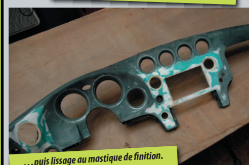
Voilà le tableau de bord prêt à mastiquer avec les 2 nouvelles aérations de chaque côté...
