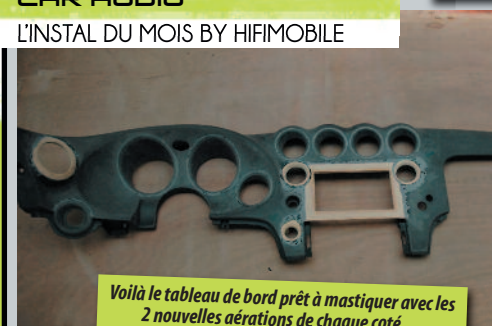
masticage du tableau de bord avec de la résine armée...
