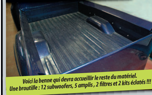
Premier problème : le remplissage de l'essence se fait par le fond de la benne. Une modification s'impose.
