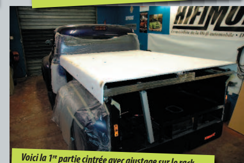
Soudure du rack sur les charnières et des fixations de vérins électriques, chacun pouvant lever 80 kg...
