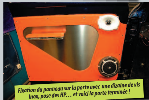
Fabrication de la deuxième plaque du panneau, assemblage et mise en place des supports de HP, tweeter et medium.
