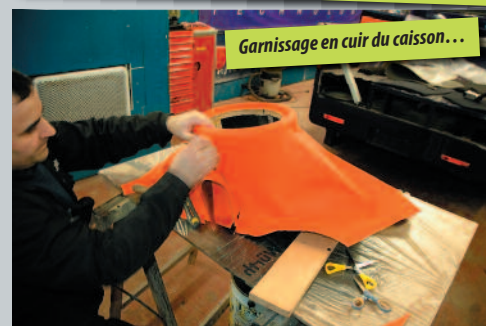
Comme la cabine est indépendante de la benne, il faut y intégrer un petit caisson. Pas le choix : ce sera au centre de la cabine sous le tableau de bord avec un support de sub en medium
