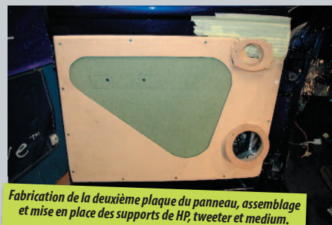
Masticage des supports grâce à de la résine armée avant ponçage et ajustage sur la porte...
