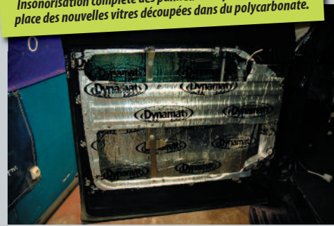
Après le système de verrouillage sur mesure, insonorisation complète de la caisse...
