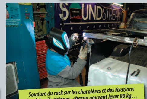
Fabrication et soudure du châssis en Inox
