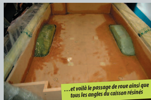
Application de la résine liquide...
