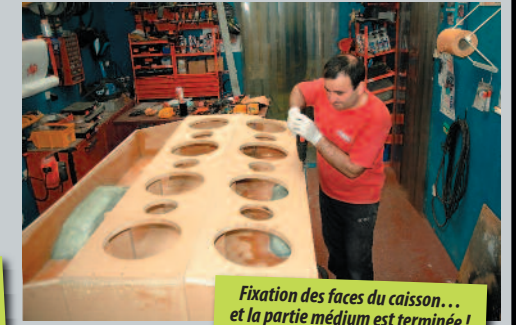
Ajustage du fond de caisson puis mise en place de renforts au centre du caisson permettant de retenir les 160 kilos des subwoofers.
