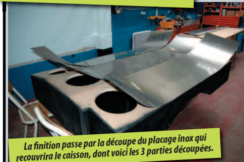
Voilà les 3 faces terminées, permettant d'accueillir les 12 subwoofers et 9 événements !
