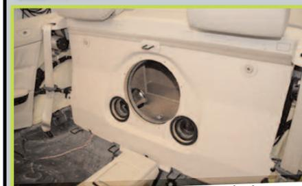
Garnissage en cuir puis fixation de la face sur le caisson.
