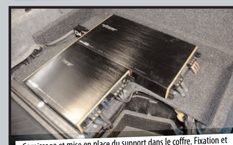
Garnissage et mise en place du support dans le coffre. Fixation et câblage des amplificateurs. Cela pourrait être terminé mais...
