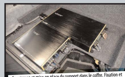
Garnissage et mise en place du support dans le coffre. Fixation et câblage des amplificateurs. Cela pourrait être terminé mais...
