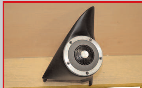
Après une peinture noire, mise en place du tweeter sur son support.
