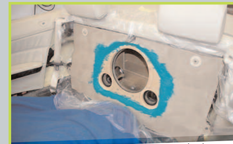
Mise en place de garniture et résinage sur la face du caisson.
