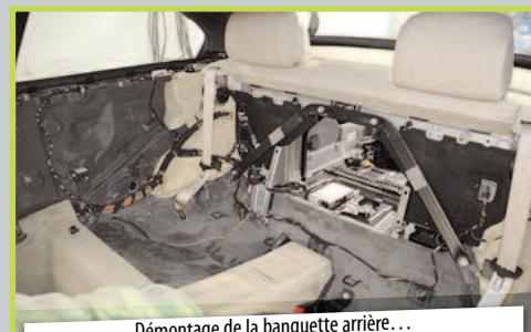
Démontage de la banquette arrière...
