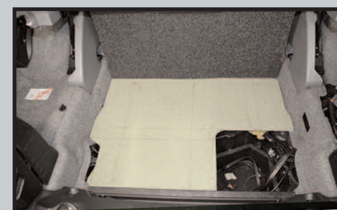
... puis fabrication d'un support en medium pour accueillir les amplis.
