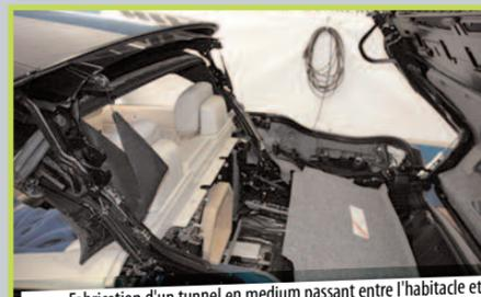
Fabrication d'un tunnel en medium passant entre l'habitacle et le coffre... et sans que cela gêne le mécanisme du toit escamotable !
