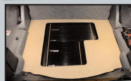
Pour la finition : fabrication d'un cache ampli en medium.
