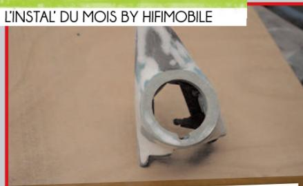
Résinage et ponçage du support.
