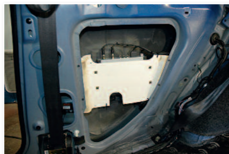
Mise en place du tuner TNT et câblage de celui-ci.
