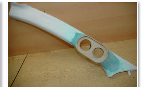
Fixation des cales sur les montants avant résinage et ponçage.
