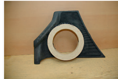
Découpe des grilles et fixation de cales en medium sur les grilles.
