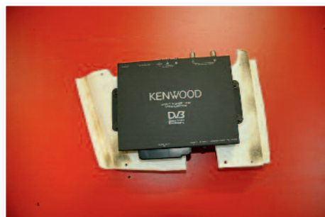
Tant que l'arrière est démonté, autant en profiter pour y placer des éléments comme le tuner TNT. On y réalise un support.
