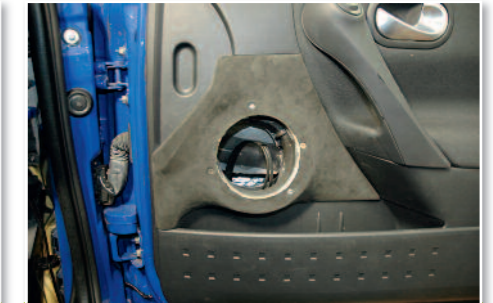
Garnissage en alcantara du support avant fixation du support par vissage sur la porte.
