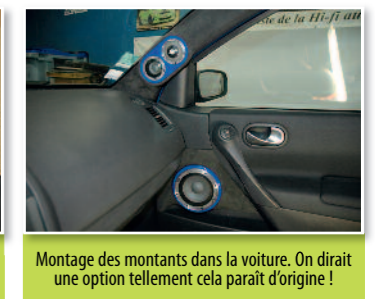
Fixation des flasques peintes sur les montants puis des medium/aigus.
