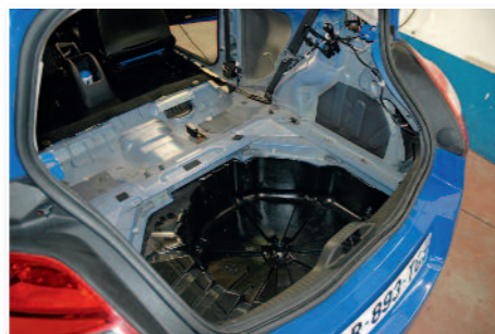
Démontage complet des garnitures arrière ! On ne peut pas faire d'installation digne de ce nom sans démonter.
