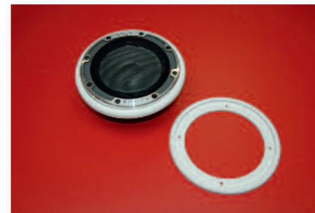
Fabrication d'entourages de HP en komacel et création des arrondis à la défonceuse.
