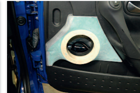
Résinage des cales sur les grilles pour renforcer le support, ponçage et ajustage sur la porte.
