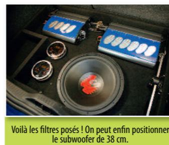
Fabrication de la plaque de fond de coffre avec des ouvertures pour le subwoofer puis ajustage.
