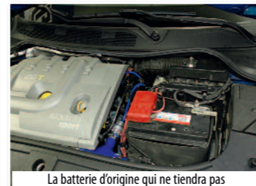
La batterie d'origine qui ne tiendra pas la secousse... à remplacer !
