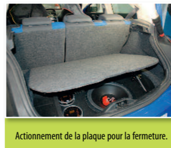
Mise en place des flasques latéraux de fond de coffre puis pose de la plaque de protection après garnissage.
