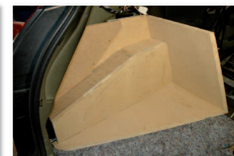
Fabrication du caisson en divers éléments.
