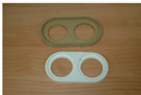
Fabrication de la contre flasque, avant leur accouplement.
