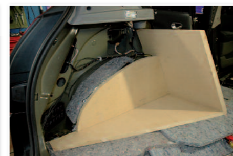
Dégarnissage du coffre puis fabrication du fond de caisson en medium.
