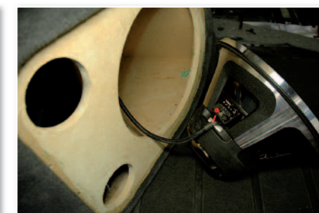
Câblage du subwoofer.
