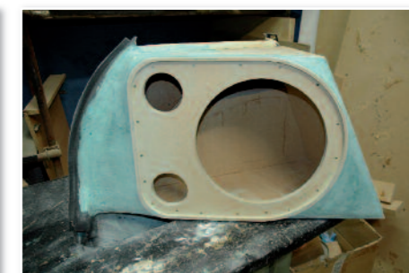
Démoulage puis ponçage du caisson.
