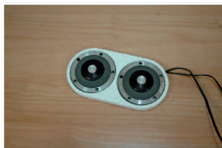
Fabrication d'un double support pour les tweeters en komacel.
