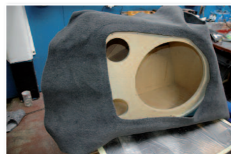
Garnissage du caisson en moquette.
