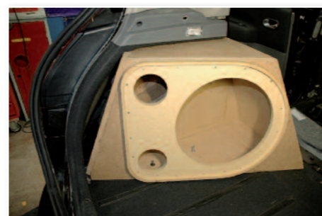
Voilà le caisson terminé avec sa face avant, ajusté dans le coffre.
