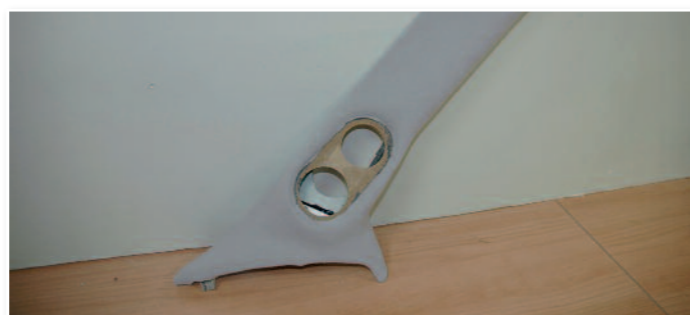
Garnissage des montants.
