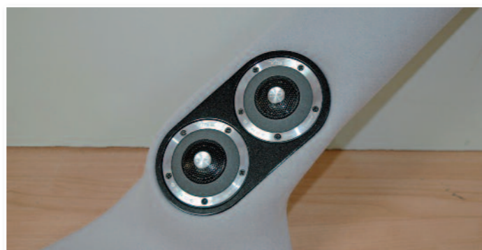
Mise en place des flasques sur les montants puis fixation des tweeters.
