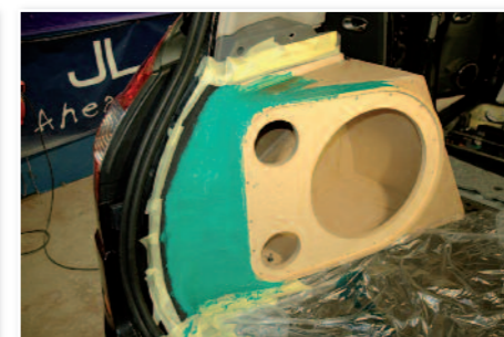
Résinage contre l'aile.
