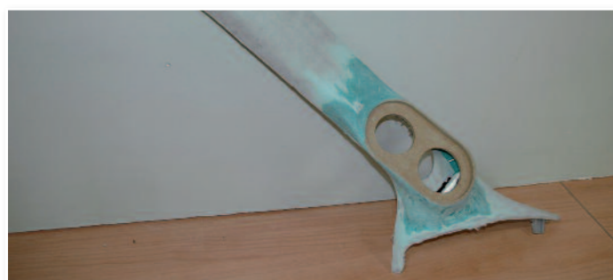
Résinage puis ponçage des supports sur les montants.
