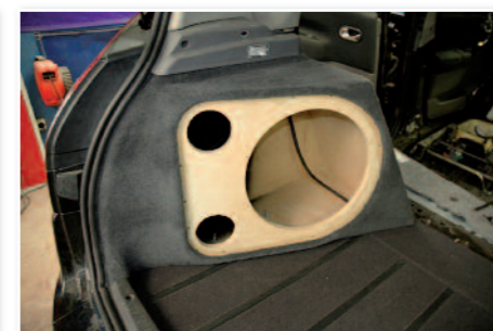
Fixation du caisson garni dans le coffre.
