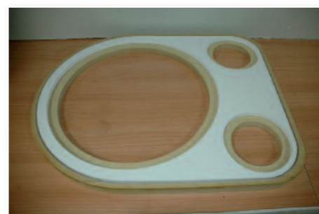
Voilà les flasques terminés, en komacel et en medium.
