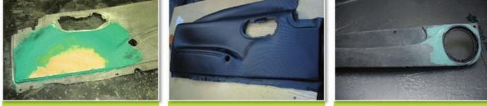
Masticage du panneau au mastic armé puis ponçage.
