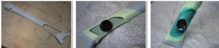
Démontage et découpage des montants de pare-brise.
