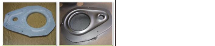
Défonçage du support et ponçage pour lui donner une forme bombée.
