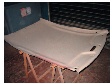
Voilà le plafonnier démonté.
