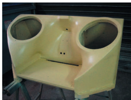
Mise en apprêt du caisson.
