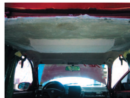
Résinage de la toile sur le plafonnier.
