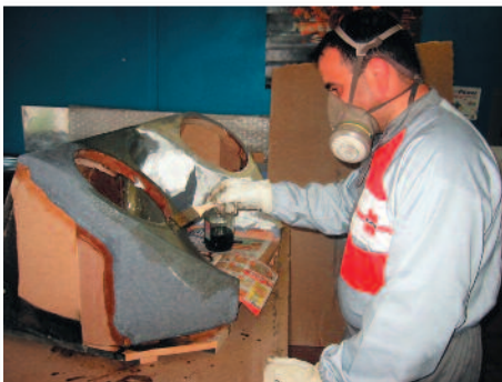
Résinage du caisson avec de la résine liquide.
