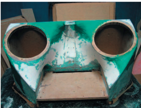
Masticage du caisson en résine armée.
