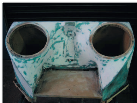
Ponçage du caisson.
