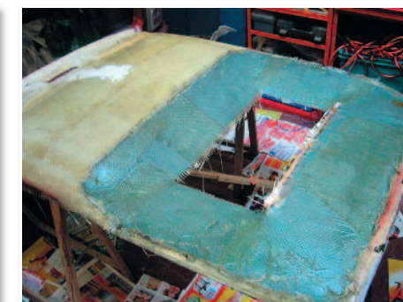
Renfort du plafonnier avec de la fibre de verre.
