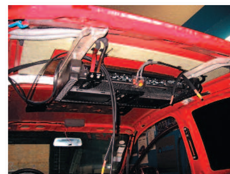
Câblage de l'ampli.
