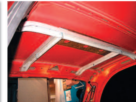
Fixation du châssis au plafond de la Corsa sur les renforts bien sûr.
