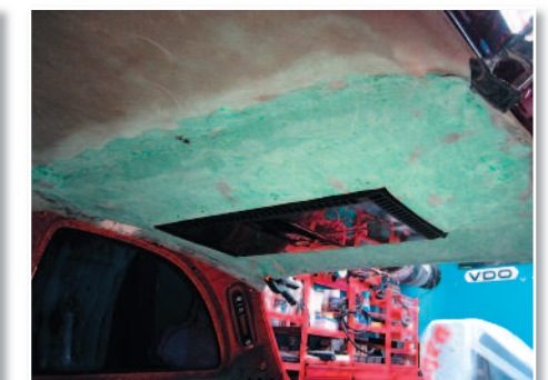
Voilà le plafonnier après résinage et ponçage.
