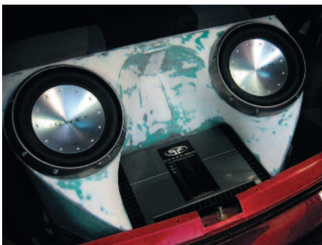
Premier ajustage du caisson dans le coffre avec le matériel.
