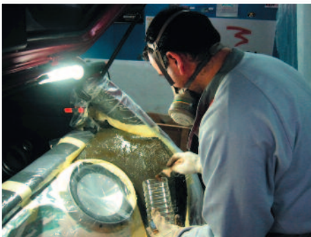
Application de la résine liquide sur les caches latéraux.
