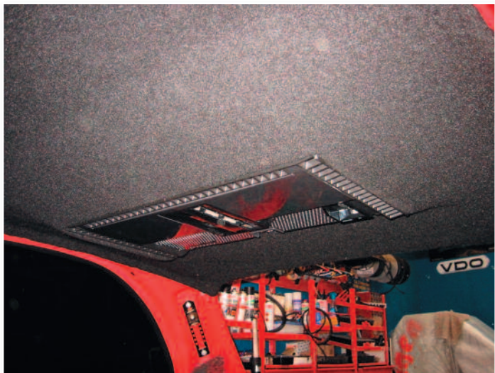
Mise en place du plafonnier qui se marie parfaitement autour de l'ampli.
