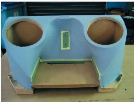
Voilà le caisson qui a prit sa forme définitive grâce à la toile.
