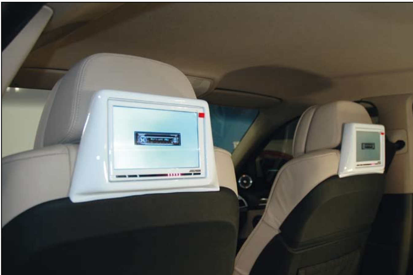
La fixation étant derrière la garniture de siège, le système reste parfaitement amovible sans laisser de trace pour une revente ultérieure du véhicule. Une fois tout remonté, l'écran est clipsé dans son support.
