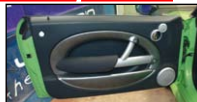
D'origine, la Mini possède un emplacement de 16,5 cm en bas de porte et un emplacement de tweeter en haut de la garniture de porte.
