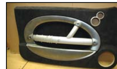
Après ponçage de la forme, le panneau de porte est habillé avec de l'alcantara noir.
