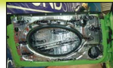
Les portes sont entièrement insonorisées au Dynamat. Ça paraît simple comme ça, mais pour le faire aussi bien, cela prend beaucoup de temps.
