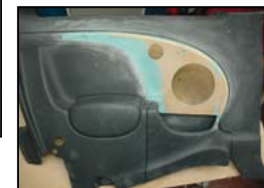
Les HP sont situés dans les flancs arrière. Emplacement petit, support pas assez rigide, un gros travail est nécessaire pour en tirer partie.
