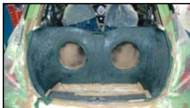
Le cache du caisson est réalisé en fibre et résine. Il vient en affleurement des trous des subs, pour dissimuler les fixations des subwoofers.
