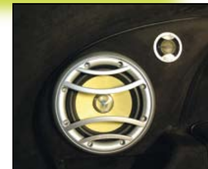
Comme pour les portes avant, le panneau est recouvert d'alcantara noir avant le montage du kit Focal. Les grilles ont également été repeintes : on a ainsi un montage efficace, discret tout en étant design !
