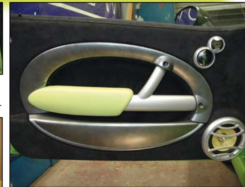
La grille des woofers et le support des tweeters sont repeints dans le même gris aluminium que la console centrale. Avec une porte ainsi modifiée, le Focal 165 KRX2 peut s'exprimer pleinement.
