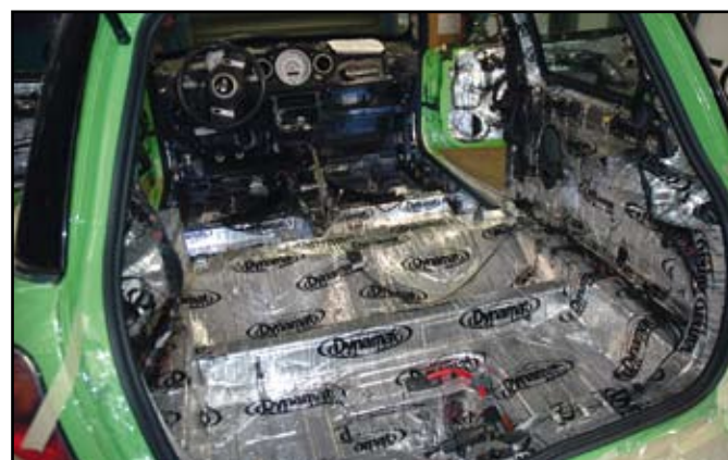
Du sol au plafond, dans les moindres recoins, la Mini a été insonorisée au Dynamat : un travail de titan, puisqu'il a fallu démonter tout l'habitacle.
