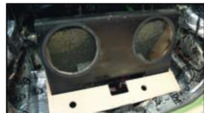
Un rack en MDF permet de loger les deux amplis Vibe. Les petits trous ronds correspondent au ventilateur des amplis.
