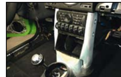
Les jambes et le bas de la console centrale sont remoulés en fibre pour permettre une parfaite intégration du combiné double DIN.
