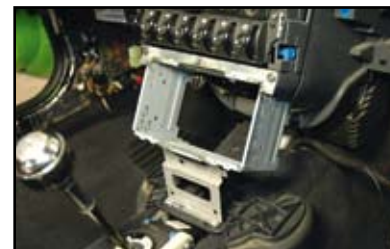
Le berceau du double DIN Pioneer est fixé sur la console centrale.
