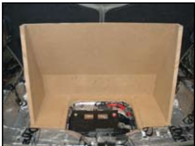
Un caisson en MDF de 20 mm est fabriqué au centre de coffre.
